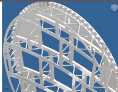
LP1 endplate Spaceframe construction (Av: 7-8%X)
