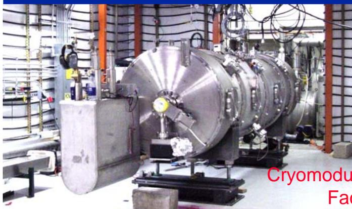
Cryomodule Test Facility
