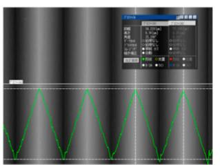
深さ10μm、S1000rpm、F1mm/min、助走路無
