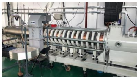
2020年 650MHz/800kW速调管样管
