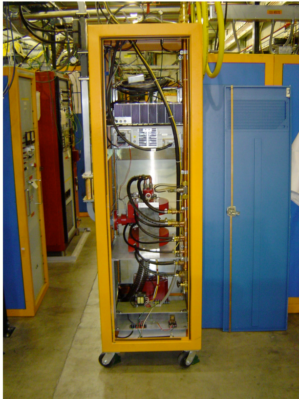
3.9 GHz 80 KWatt Klystron
