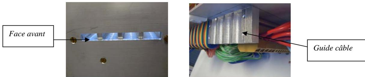
(B) coté détecteur en ressortant les fils grounds des câbles au niveau du connecteur et en utilisant une autre tresse on peu interconnecter les 60 câbles ensemble.
