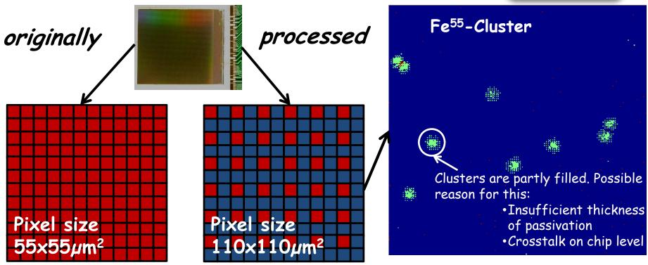
■ Pixel acitve■ Pixel passivated
