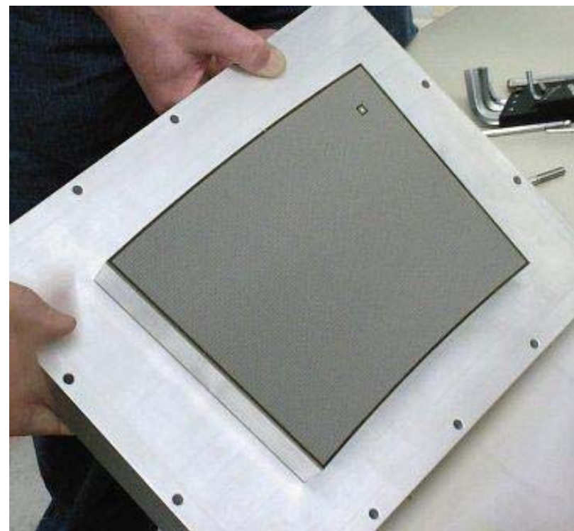
Carbon loaded kapton Micromegas module
