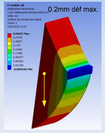
Directionnal deformation axis Z (// gravity) (mm)
