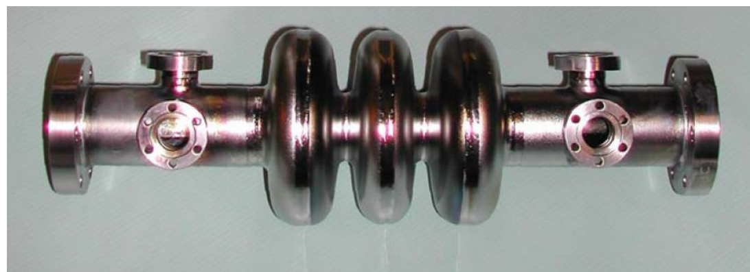
3.9GHz prototype (実物は9セル)
