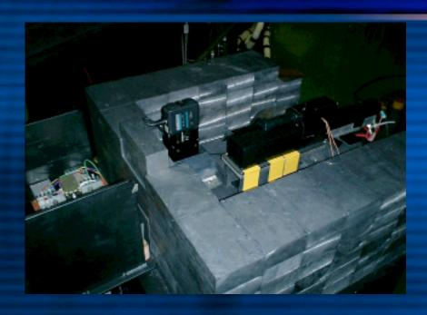
collimator + pure Csl (laser wire ; E<sub>ph</sub><30MeV)
