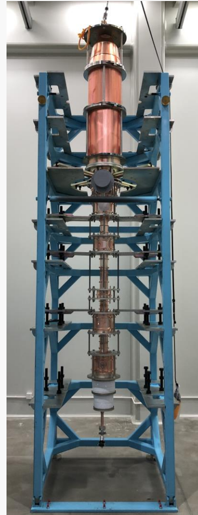
The first CEPC 650MHz 800kW Klystron
