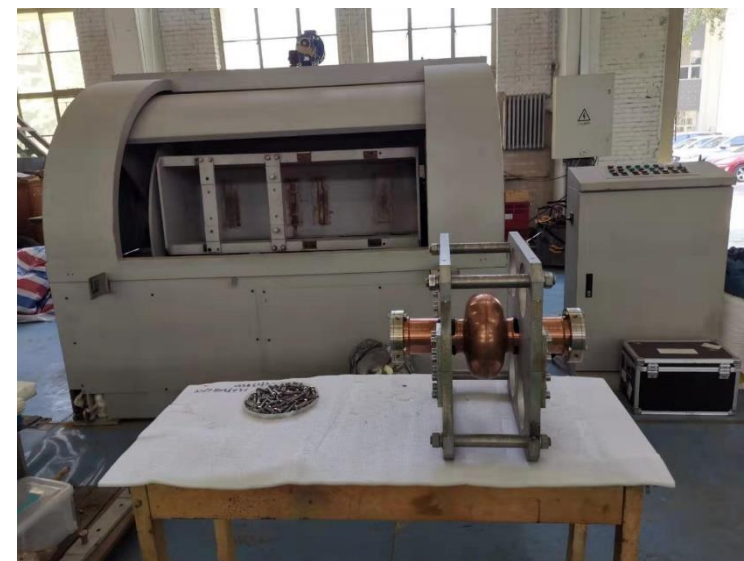
CBP (with fine polishing step) 120 um + EP 20 um + annealing + EP 20 um
