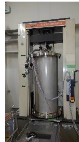
低温引張試験機 (超伝導低温工学センターと共同開発)
