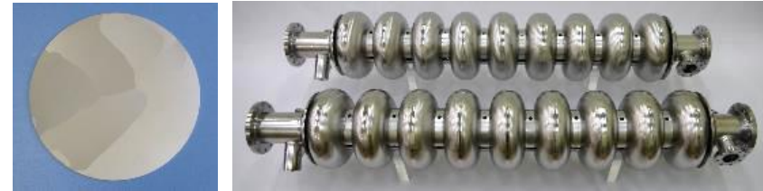
ダイレクトスライス中純度LG-Nbで製造したKEK-4/5号機
