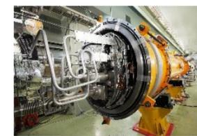
2K超流動ヘリウム冷凍容器“Cryomodule”
